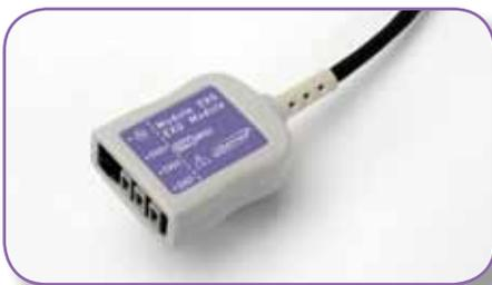
Módulo ExG para la adquisición de EEG, EOG, EMG, ECG. (3 canales máximo)
